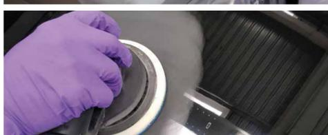
► Disco de espuma flexible 3M™ Hookit™ P800-P1000 lijado de la superficie grande de pintura original.
